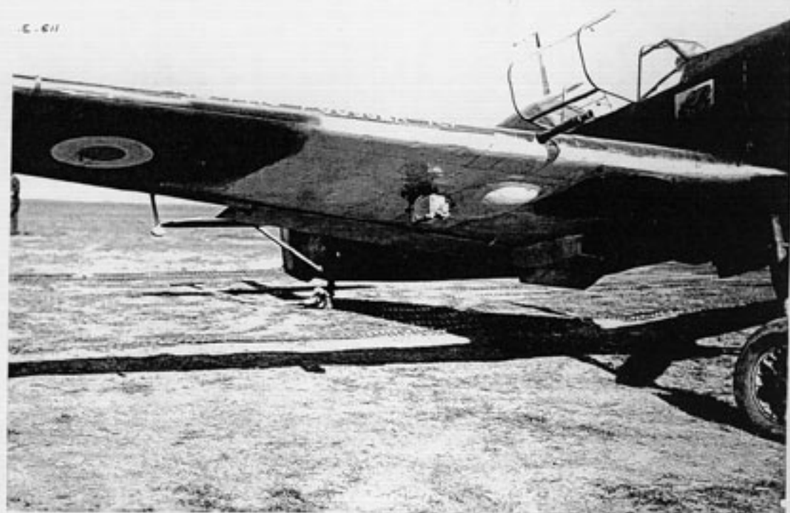
Installation de la cinémitrailleuse
